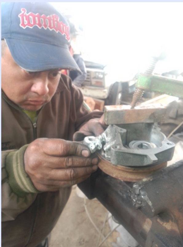
Realización de soldadura en una pieza de aluminio Taller Metalúrgico Gato Negro.
