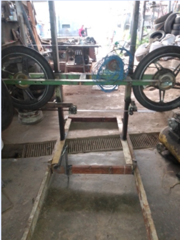
Cierra Cinta fabricada de forma artesanal para cortar madera
